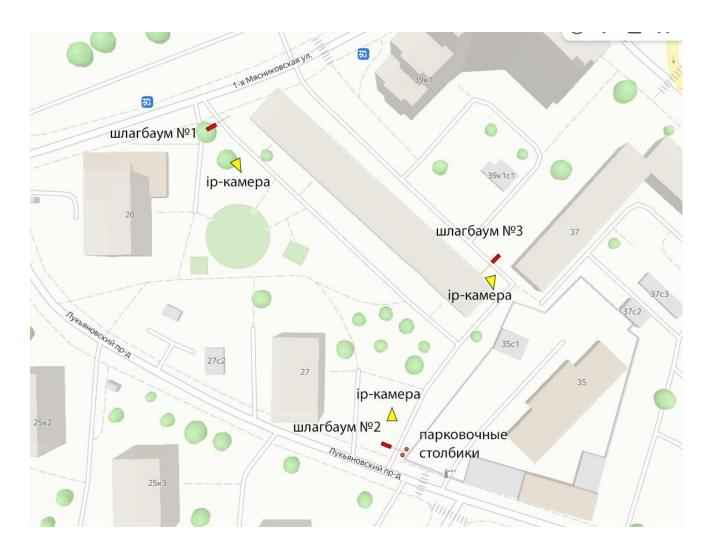
**Шлагбаум № 1,2** – электромеханический антивандальный откатной. Оснащён, вызывной панелью и видеокамерой для осуществления диспетчеризации.
