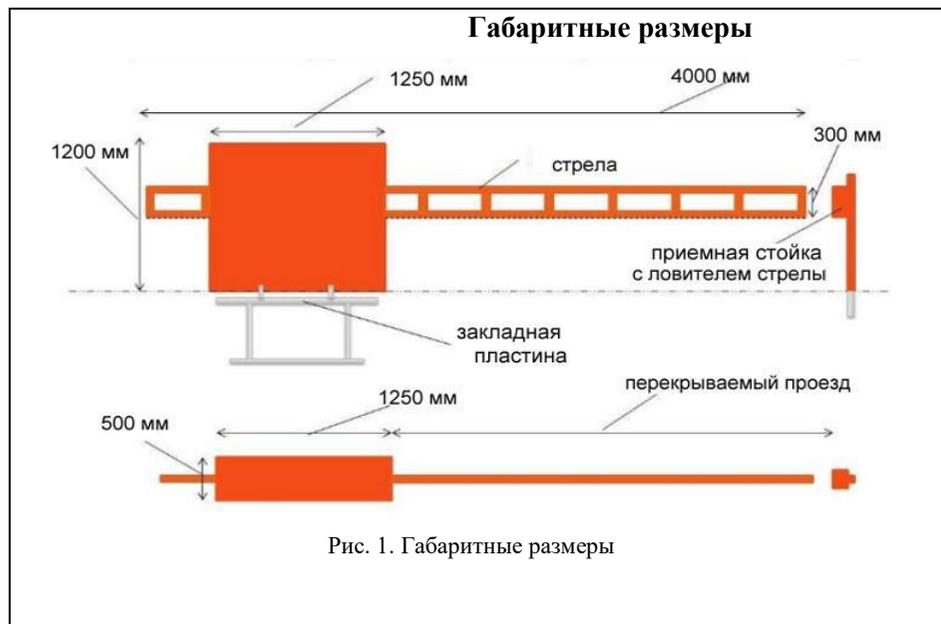
Рис. 1. Габаритные размеры
