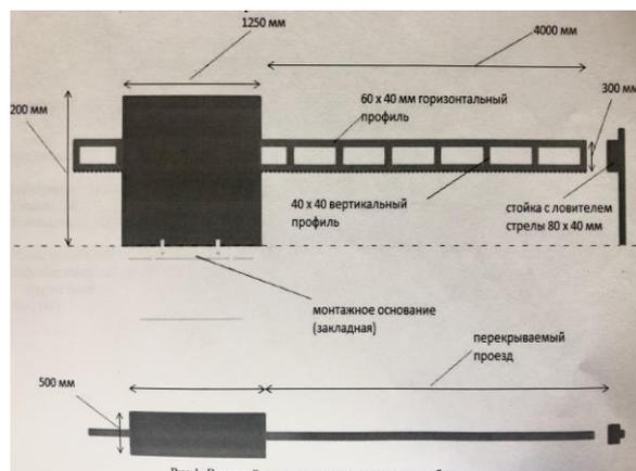
Рис. 1. Внешний вид и размеры откатного шлагбаума.
