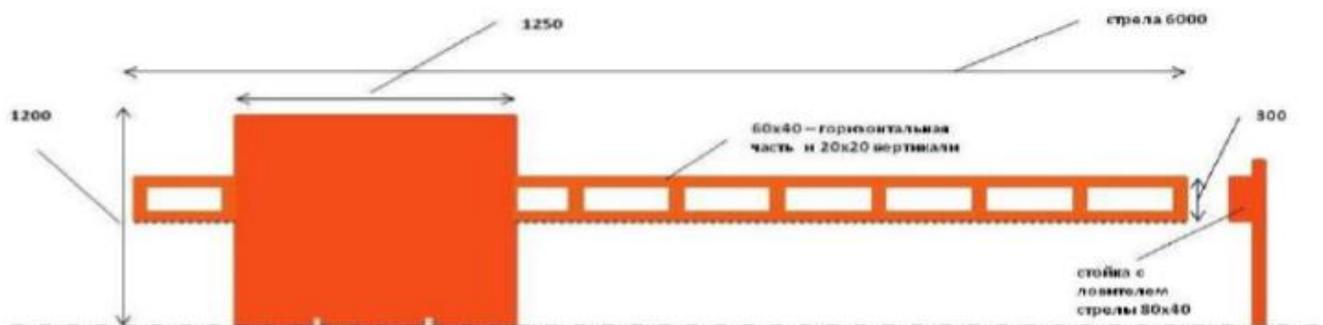
Автоматический антивандальный шлагбаум с вызывной панелью и аудио-видео связью с круглосуточной диспетчеризацией откатного типа.
