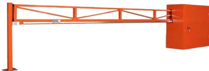
Шлагбаум электромеханический откатного типа для контроля въезда на дворные территории жилых кварталов на базе привода Nice RB250. Состоит из металлической тумбы, установленной на закладном элементе и стрелы 5000 мм. Ширина проезда 4 м. Шлагбаум снабжен вызывной панелью для вызова диспетчера и видеокамерой. Стрела откатывается вправо (со стороны въезда во двор). Цвет шлагбаума оранжевый.
