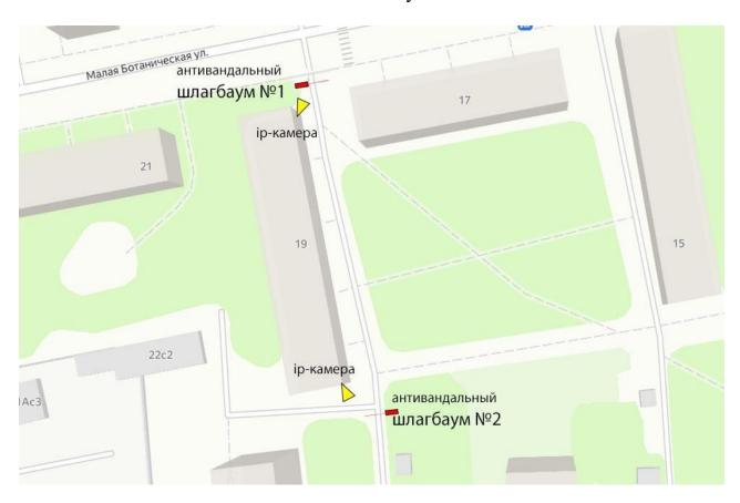
Шлагбаум № 1, 2 — электромеханический откатной антивандальный "Автопроезд", с шириной перекрываемого проезда до 5 м.
