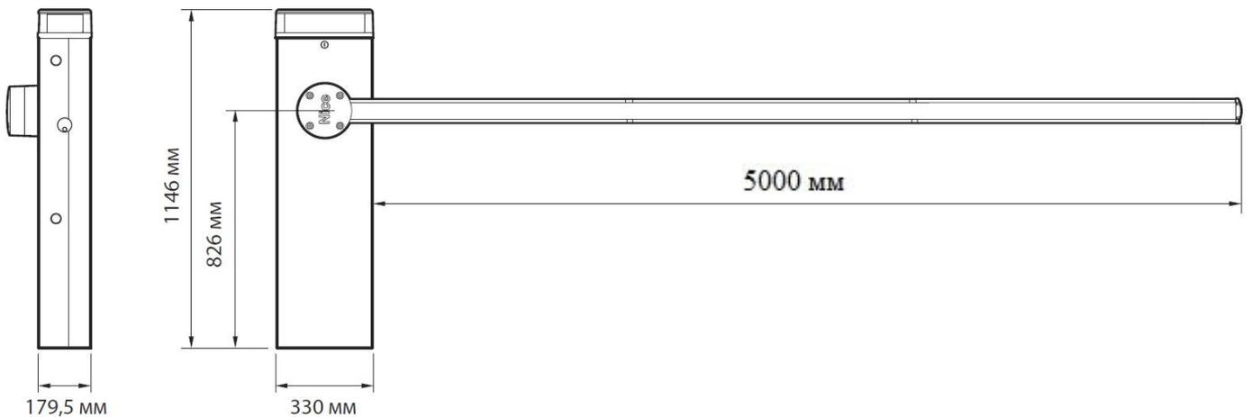
Электромеханический шлагбаум серии BAR со встроенным блоком управления. Для проезжей части шириной до 5 метров.
