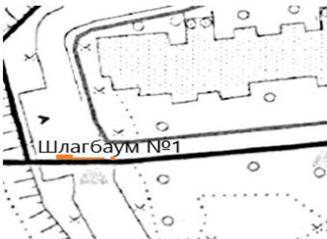
Размещение тумбы откатного шлагбаума на въезде с Коломенского проезда (со стороны Библиотеки № 136 им. Толстого). Длина стрелы шлагбаума 5 метров (ширина перекрываемого проезда 4 метров), высота тумбы от земли 1100 мм.
