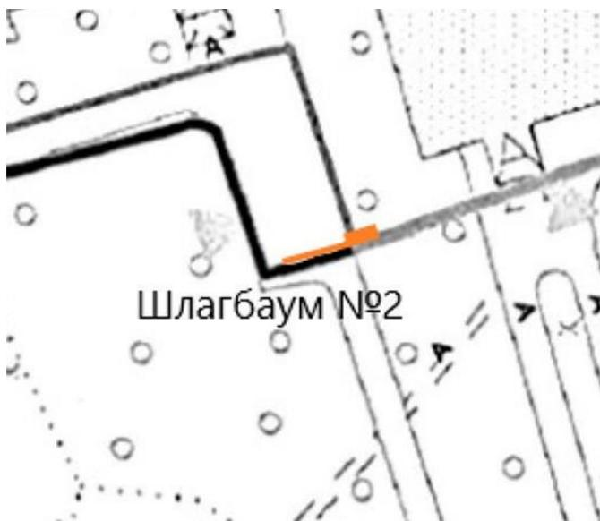
Размещение тумбы откатного шлагбаума на въезде с улицы Садовники (со стороны 1 подъезда). Длина стрелы шлагбаума 6 метров (ширина перекрываемого проезда 5 метров), высота тумбы от земли 1100 мм.
