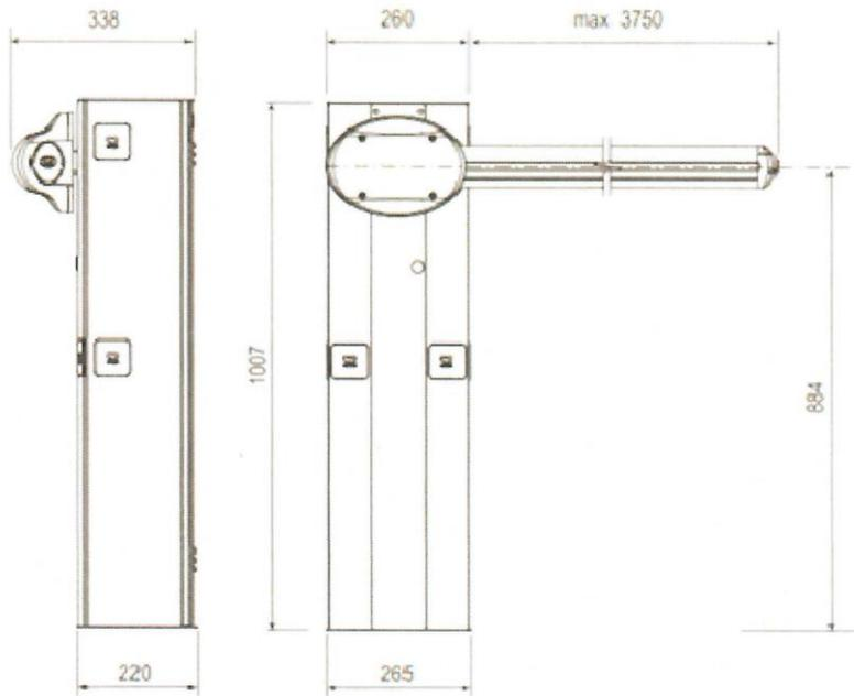
Шлагбаум состоит из круглой алюминиевой стрелы (антиветер) белого цвета с зеркальными отражательными поперечными полосками красного и белого цвета, а также стальной стойки, обработанной катафорезом и покрашенной полиэфирной краской оранжевого цвета. Стойка шлагбаума снабжена сигнальной лампой желтого цвета для предупреждения водителей транспортных средств и пешеходов, об опускании (поднятии) стрелы шлагбаума.
