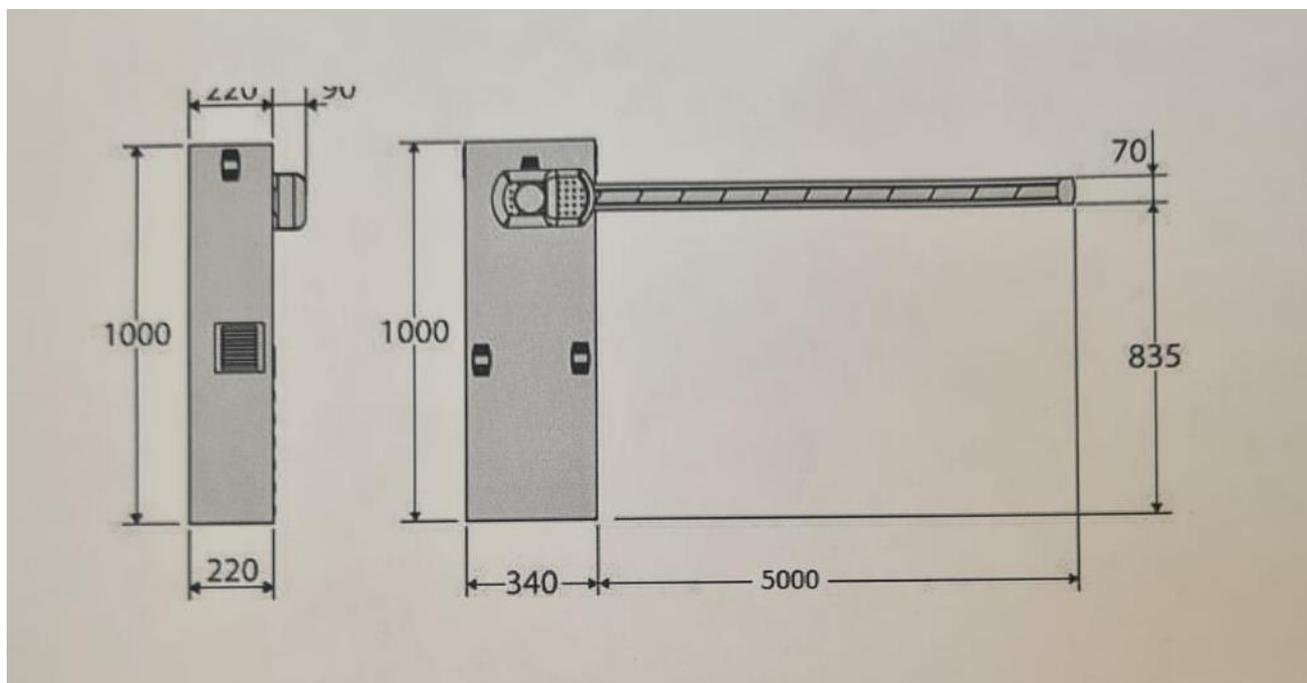
Шлагбаум крепится болтами на металлическую закладную вмонтированную в бетонное основание. На стойке шлагбаума находится электрический привод, а также блок электронного управления. Привод, поднимающий стрелу, состоит из электродвигателя, редуктора. Шлагбаум оснащен регулируемыми элементами безопасности, а также устройством фиксации стрелы в любом положении и ручной расцепитель для работы в случае отсутствия электроэнергии.
