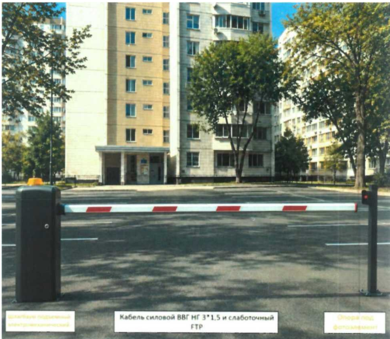
Рис. 2. Проектная визуализация оборудования на месте установки.
